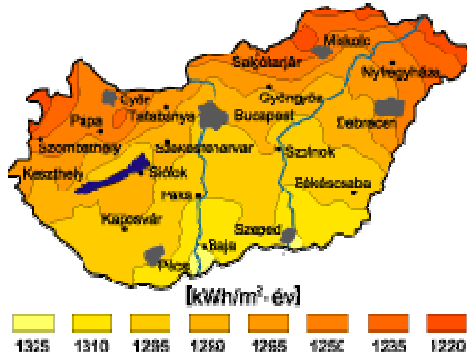
Vízszintes felületre érkező napsugárzás [kWh/m 2 ·év]
